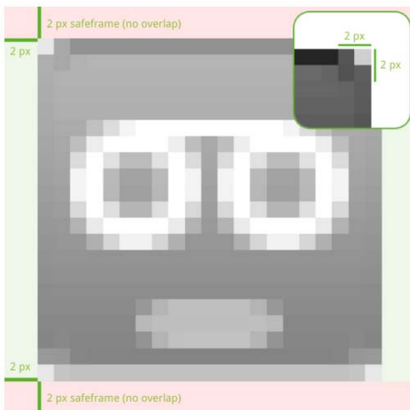
図9: ステータスバーアイコンで使用するセーフフレームと丸めた角。アイコンサイズは 25 x 25
